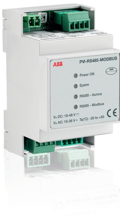
La famiglia di dispositivi PVI-RS485-MODBUS di ABB consentono di convertire il protocollo proprietario Aurora Protocol in protocolli di comunicazioni di tipo ModBus RTU o ModBus TCP.
